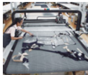
CAMシステム(自動裁断機)で、表生地、裏地、芯地を効率よく裁断
