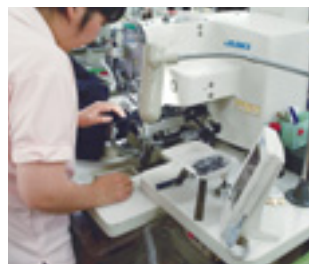
鈕付けミシン導入により均一で安定した加工を実現
