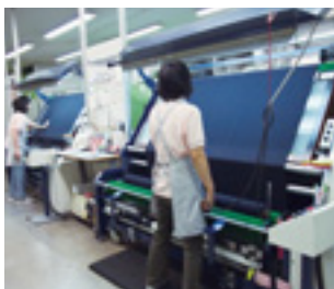
検反機導入により生地のカズ等を細かく検査し、最良の生地のみを使用
